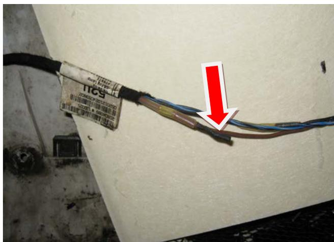
Разрежьте провод правой ПТФ в районе левой ПТФ, удлините провода правой ПТФ и провода идущего от разъема жгута бампера, заизолируйте места соединений, выведите получившийся жгут в район АКБ, подключите разъем бампера и установите бампер на автомобиль. CAN шину удобно подключить в разъеме возле АКБ, CAN HI синий, CAN LOW белый.
